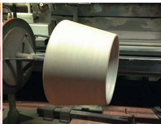
Verschleißschutz an einem Rotor. Corrosion protection on a rotor.
